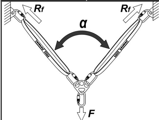
Atunci când folosiți pentru ancorare două bucle, într-o configurație de tip triunghi, mențineți unghiul ( $\alpha$ ) dintre cele două bucle **cât mai ascuțit!** Un unghii prea mare între acestea multiplică forța transmisă punctelor de ancorare ( $R_f$ )! Recomandăm folosirea unor bucle cu lungimi adecvate pentru a menține întotdeauna unghiu **mai mic de 60°!**
