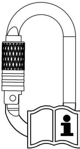
**ATENȚIE !** Pentru cuplarea buclelor sau mijloacelor de legătură se vor folosi carabiniere conform EN 362. Citiți cu atenție instrucțiunile de utilizare ale carabinierelor și ale celorlalte componente pe care intenționați să le folosiți pentru a vedea modalitățile corecte de utilizare și a valida compatibilitatea acestora!
